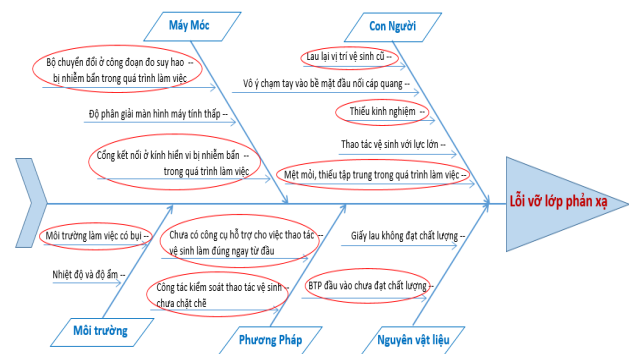
Hình 10. Biểu đồ nhân quả của lỗi vỡ lớp phản xạ bề mặt đầu nối cáp quang
